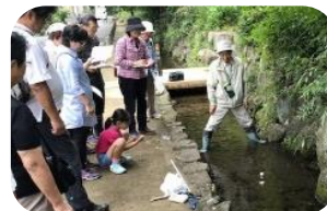
フロートを流して流量を測る
